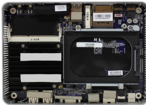
Figura 2. Vista interna (sin memoria principal y disco duro)
