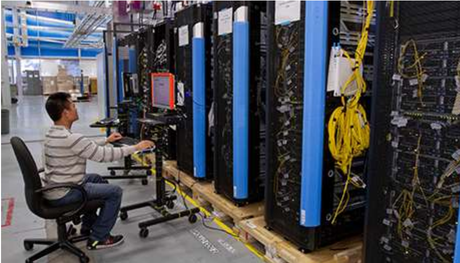
Ilustración 2 - Ejecución de pruebas de calidad en servidores (Vanian, 2015)
